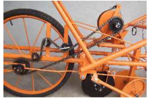
En la imagen se muestra cómo la cadena se está montada para accionar el sistema de distribución de rotor
