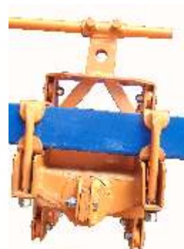
5. Colocar a barra de cambagem e o arrastador da linha
