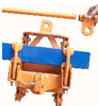
5. Colocar a barra de cambagem e o arrastador da linha
