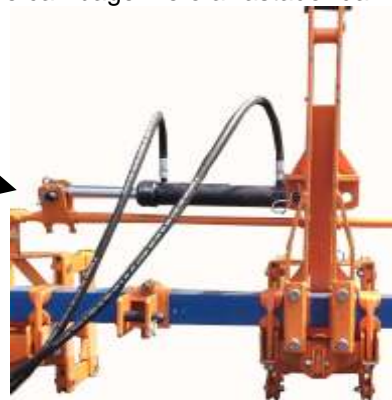
5. Colocar a barra de cambagem e o arrastador da linha
