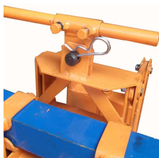
6. Passar o pino e a trava R e parafusar para fixar a guia na barra.
